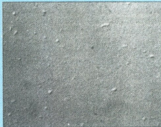
Karc: károsodás a PDM Standard szalag párhuzamosan a szalag szélével 100-szoros nagyításban.
