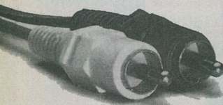
RCA-dugók – a videocsatlakozó általánosan elfogadott színe a sárga, a hangé a piros (jobb csatorna), illetve a fehér (bal csatorna)
