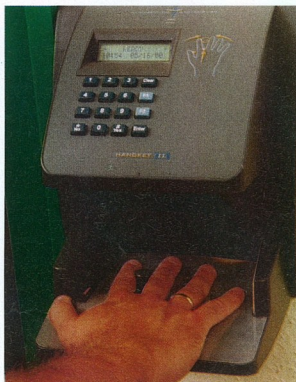
A HandKey II belépési jogosultság-ellenőrző a kézipermetriát vizsgálja – mindössze egyetlen másodpercig
