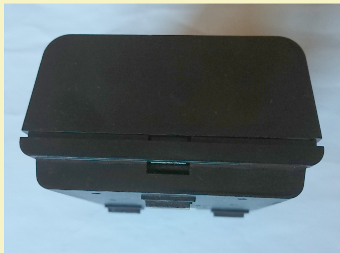
2. ábra: A készüléket a színezett alumínium fedlap alatt található két csavar fogja össze (A). A csavarok eltávolítása után a hátlapon levő fülnél kell szét pattintani a házat (B).
