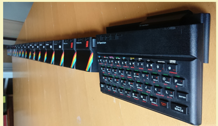
11. ábra: Ha megszüntetjük a szoftveres korlátot a Microdrive-ok számára vonatkozóan, akkor csak az elektronika korlátai szabják meg, hogy hány egységet kapcsolhatunk össze. A gyakorlati tapasztalat azt mutatta, hogy 10 egység környékén van az a határ, amit felett a rendszer nem stabil.
