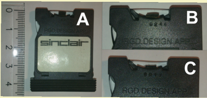
6. ábra: A Microdrive kazetta eredeti érintetlen szivaccsal (A), az első használat során a szivacs összeroskad és elkezdi elnyíródni (B). Ki idő után a felső réteg lesodródik és a szivacs maradéka szétkenődik a szalagon. A szivacs lecserélve lézervágott filcre (C).
