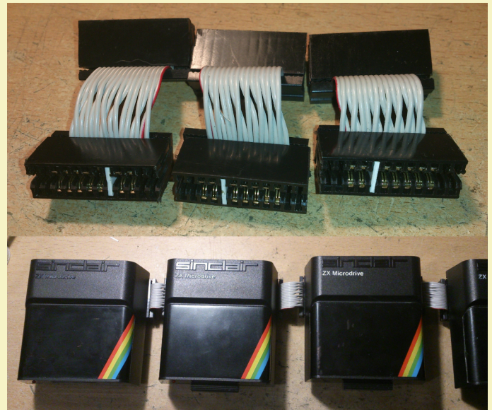
7/B. Ábra: Az előző sajnos nem vált be, inkább szalagkábelből készítettem összekötőket, amiknek az érdekessége, hogy páronként meg kell cserélni a szomszédos vezetőket.
